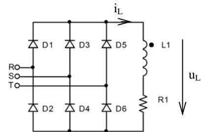
**Datos:**  $U_{red} = 380 \text{ V}$ ,  $f_{red} = 50 \text{ Hz}$ ,  $R_1 = 1 \text{ k}\Omega$ ,  $L_1 \rightarrow \infty$ ,  $V_F = 1,1 \text{ V}$ . Suponer todos los componentes ideales salvo para el apartado 4.
